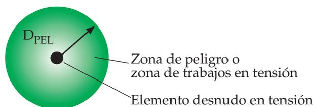
Figura 2. Zona de peligro o zona de trabajos en tensión (sin barreras).
