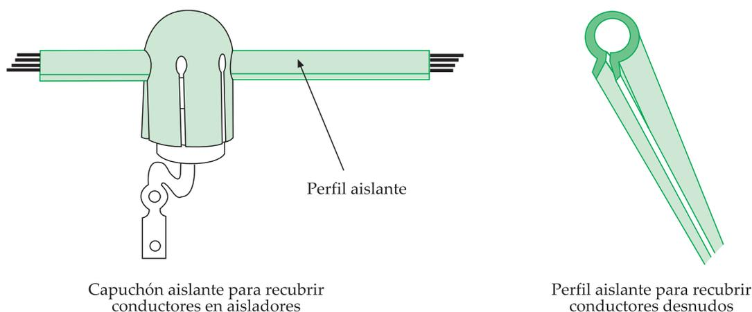
Figura 24. Elementos aislantes para trabajos por el método en contacto.
