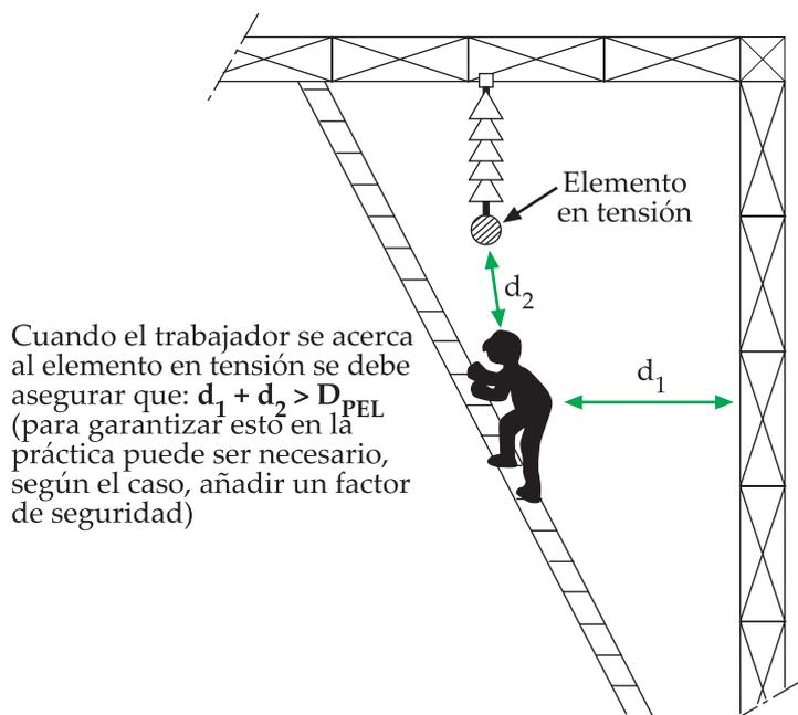
Figura 21. Método de trabajo a potencial: acceso del trabajador hasta el elemento en tensión subiendo por sí mismo a través de una escala aislante.
