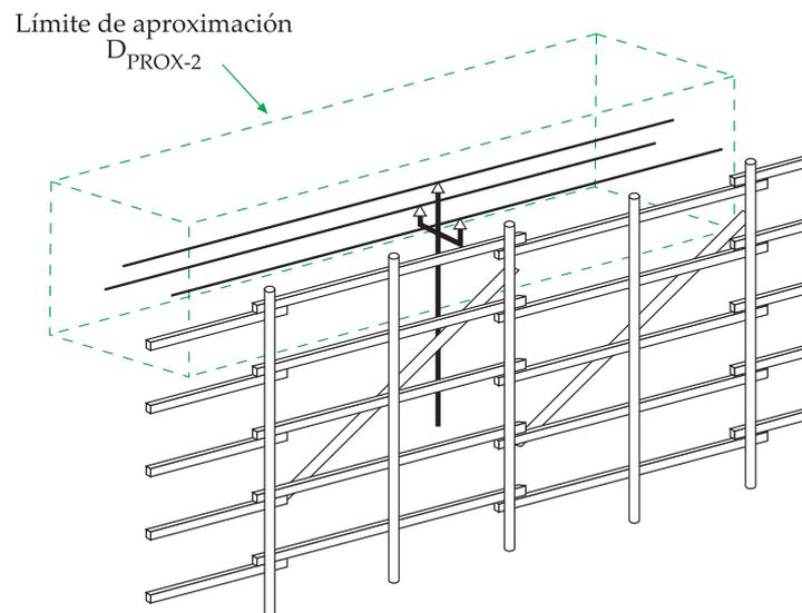
Figura 30. Ejemplo de sistema de protección para trabajos en proximidad de líneas aéreas.
