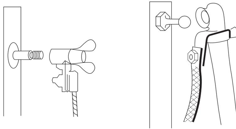
Figura 14. Puntos fijos de puesta a tierra.
