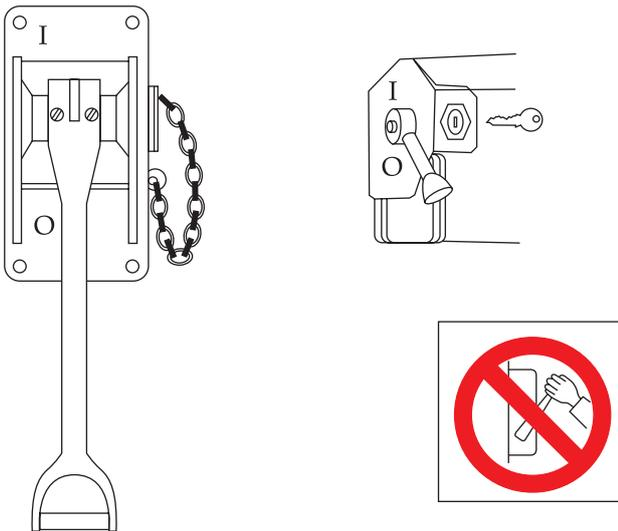
Figura 7. Ejemplos de sistemas de enclavamiento y señal de prohibición de maniobrar.
