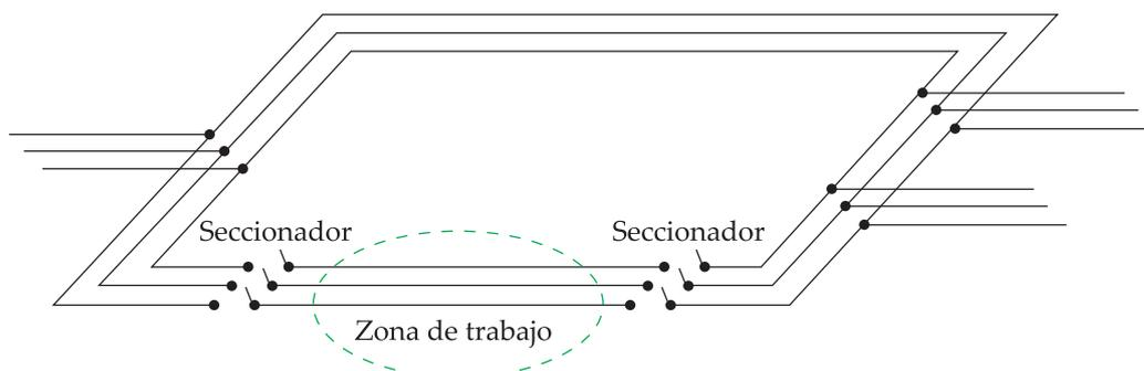
Figura 6. En instalaciones que formen parte de un lazo es necesario desconectar en los distintos lados.
