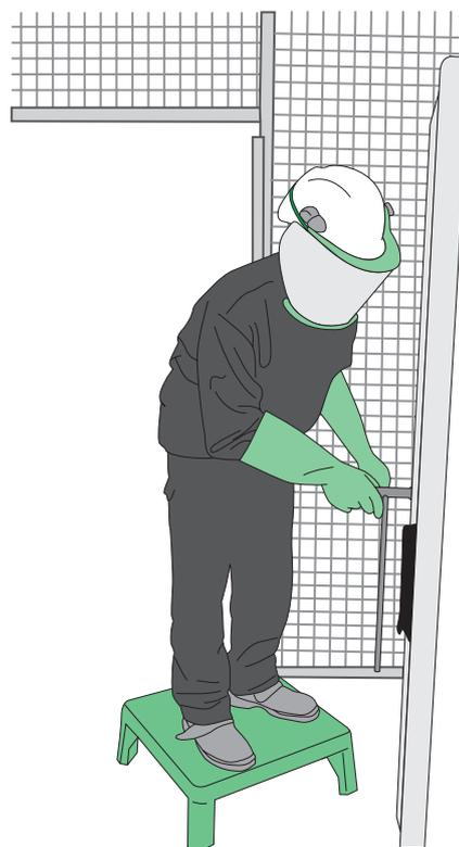
Figura 15. Colocación de la puesta a tierra en una instalación de alta tensión.
