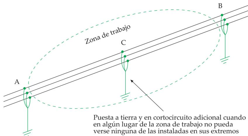
Figura 19. Puesta a tierra y en cortocircuito adicional.
