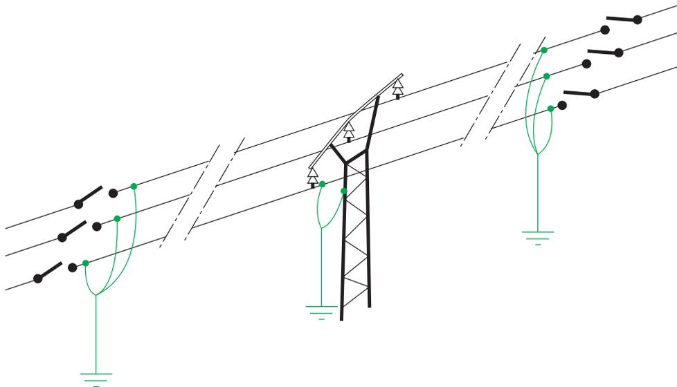
Figura 20. Disposición de las puestas a tierra cuando el trabajo se realiza en un solo conductor.
