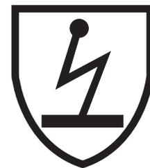
Figura 37. Pictograma relativo a equipos de protección individual antiestático que debe figurar en el mercado del equipo.
