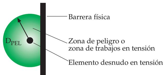
Figura 3. Zona de peligro o zona de trabajos en tensión (con barrera física).
