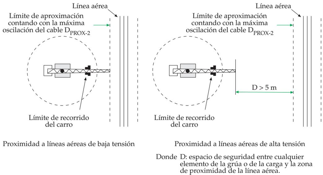
Figura 29. Ejemplos de medidas preventivas en trabajos en proximidad con grúas de pluma<sup>22</sup>.
