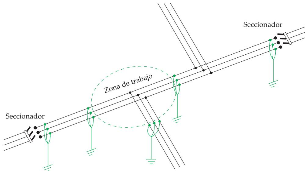
Figura 18. Puntos en los que deben colocarse las puestas a tierra y en cortocircuito.
