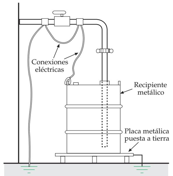
Figura 36. Conexión equipotencial en proceso de trasvase de líquidos inflamables.
