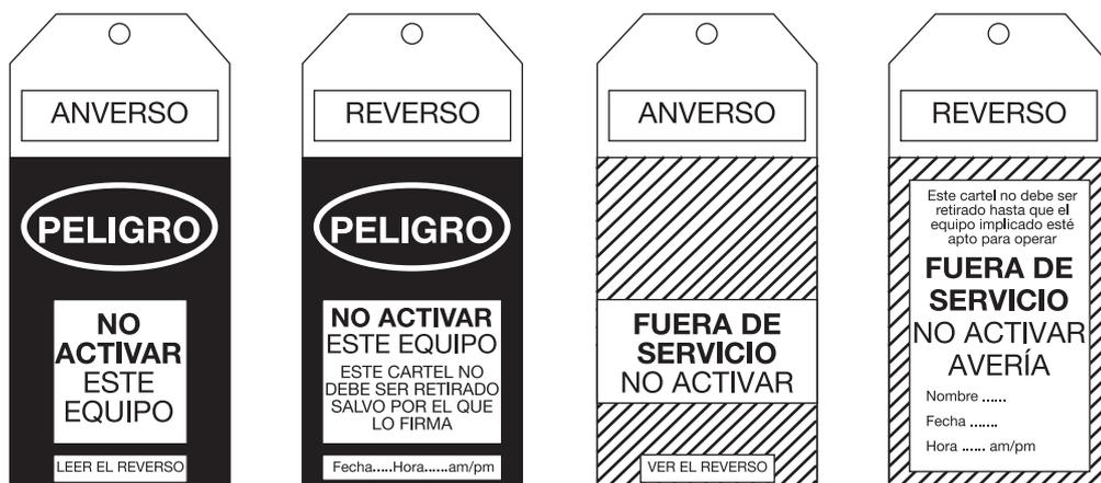
Figura 8. Ejemplos de carteles que pueden colocarse sobre los dispositivos de maniobra para prohibir su accionamiento.
