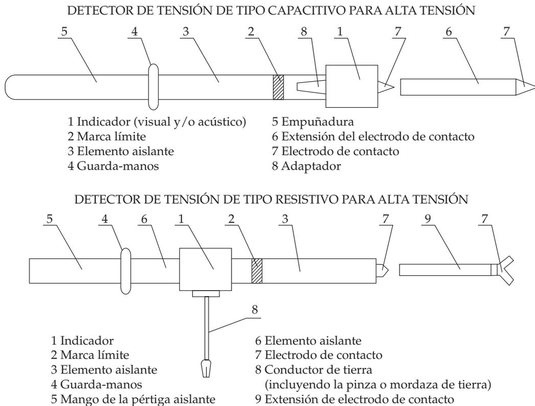
Figura 10. Detectores de tensión para alta tensión.
