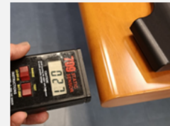
Exemple de mesurament d'estàtica realitzat a diverses taules de treball d'un edifici d'oficines
